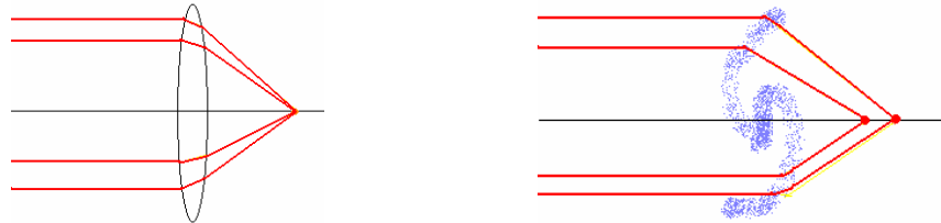
Figuras 2a y 2b. Las lentes convexas convencionales enfocan los rayos paralelos de luz hacia un punto: el foco. Las lentes gravitacionales enfocan la luz en una línea en lugar de un punto
